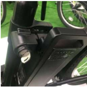
①バッテリー上部のバッテリーロックを開錠します。
