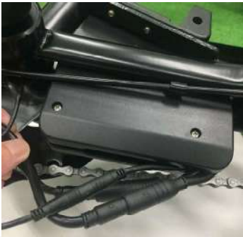
③バッテリー底部 コントローラーボックス下側のボックスの割れ目からコード類を引き出します。
