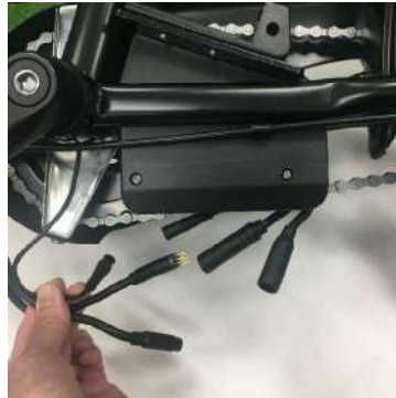
④引き出した3本のコードジョイントコネクタを引き抜き外します。
