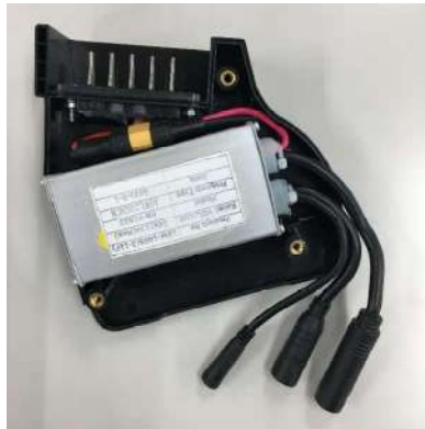
⑦コントローラーボックスを開けた状態。
